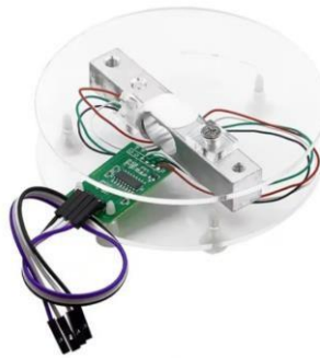
Şekil 3.4.3. Ağırlık Sensörü ve HX711
